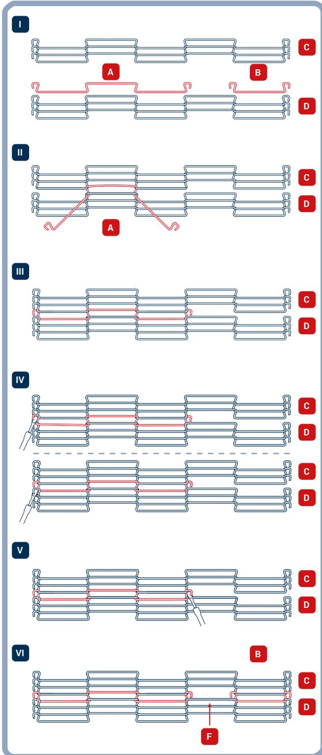
Los clips ECO se utilizan como elementos de unión para las cintas de entramado de varillas ECO.
