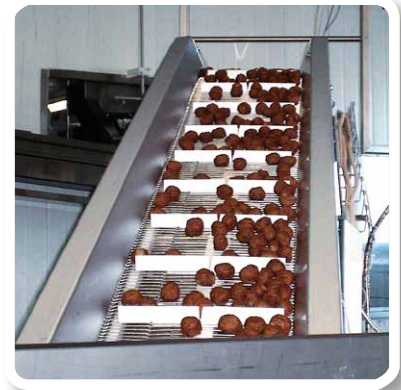
Cinta de entramado de varillas con topes de arrastre en funcionamiento (transporte ascendente de albóndigas)
