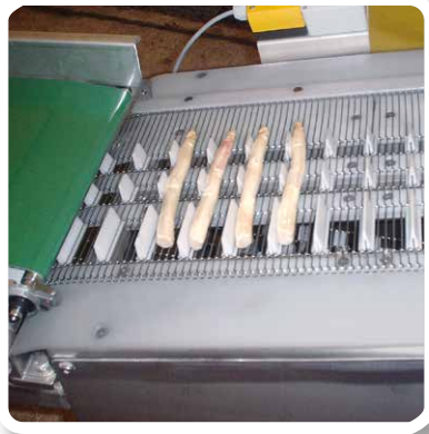
Cinta de entramado de varillas con topes de arrastre en funcionamiento (sistema de lavado y corte de espárragos)
